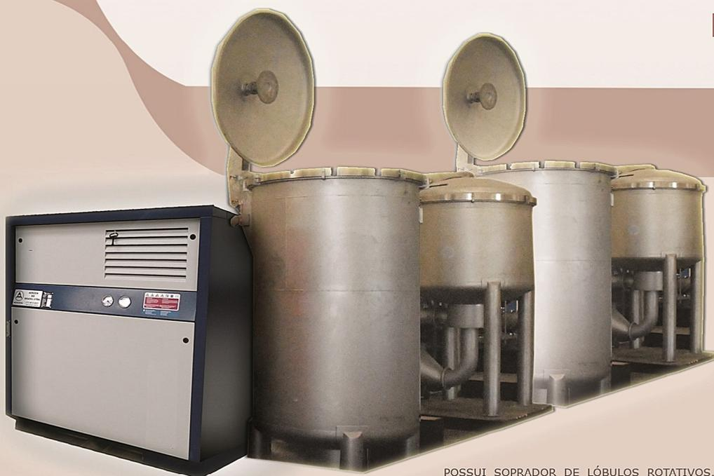
POSSUI SOPRADOR DE LÓBULOS ROTATIVOS, DE FÁCIL MANUTENÇÃO, CONFIGURADOS COM MOTORES DE CLASSE DE EFICIÊNCIA ENERGÉTICA PREMIUM IE3, POSSUI ACIONAMENTO DE VELOCIDADE VARIÁVEL COM UM CONTROLADOR INTEGRADO QUE CONTRIBUI PARA UMA OPERAÇÃO SUAVE E ECONÔMICA, FORNECENDO A SUA APLICAÇÃO APENAS A QUANTIDADE CERTA DE AR.
